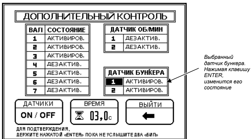
Рисунок 35. Конфигурация датчиков уровня в семенных бункерах
