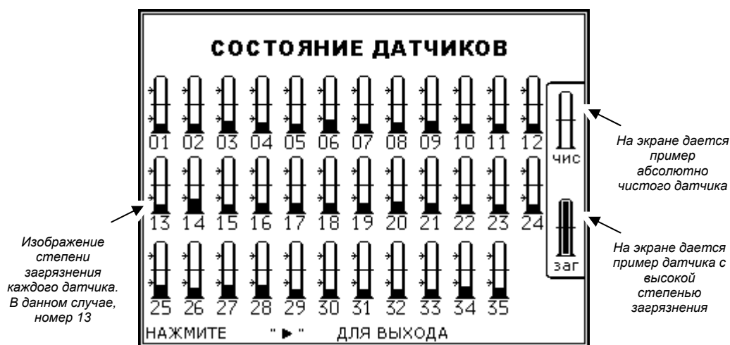
Рисунок 24. Экран визуализации степени загрязнения в датчиках семян или удобрений
