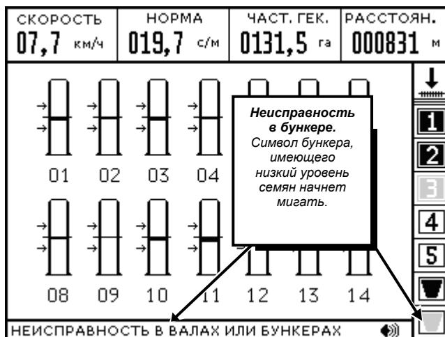
Рисунок 19. В одном баке для семян или удобрений остался низкий уровень
