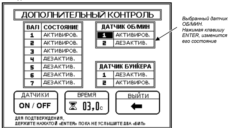
Рисунок 36. Конфигурация датчика об/мин
