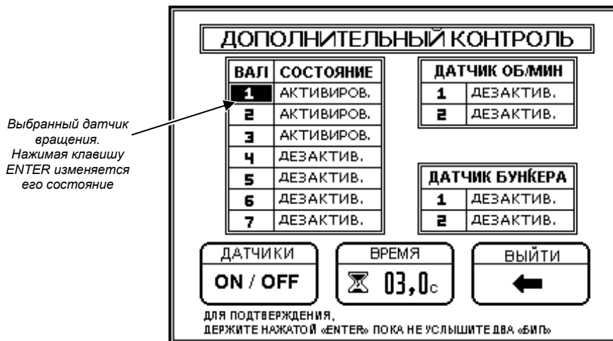
Рисунок 32. Конфигурация датчиков вращения валов
